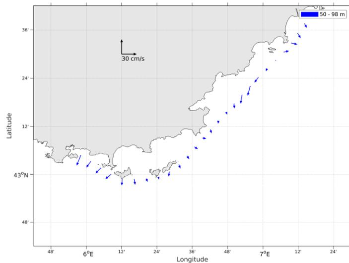
Figure 70- Vecteurs du courant de la section 1 de 50 à 100 m.
