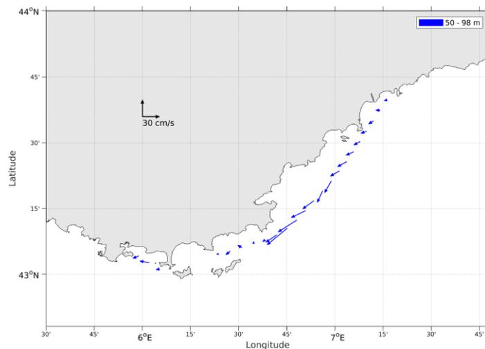
Figure 33- Vecteurs du courant de la section 1 de 50 à 100 m
