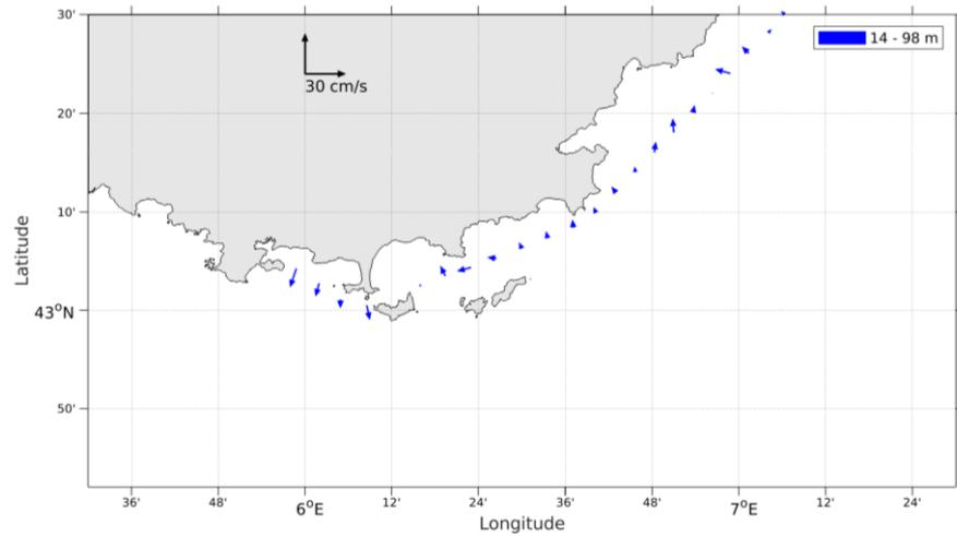
**Figure 20- Vecteurs du courant de la section 1 de 0 à 100 m**
