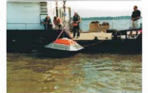
Mise en oeuvre d'un ADCP de fond RDI
