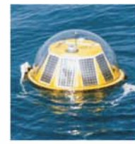
Bouée de mesures de houle directionnelle TRIAXYS Mise en oeuvre d'une bouée de houle Datawell
