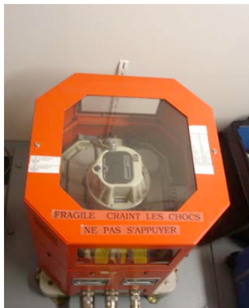
Vue de dessus du gravimètre dans son enceinte thermostatée et pressurisée
