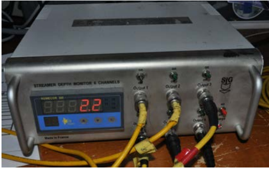
Figure 10 : Alimentation de la flûte 6 traces.
