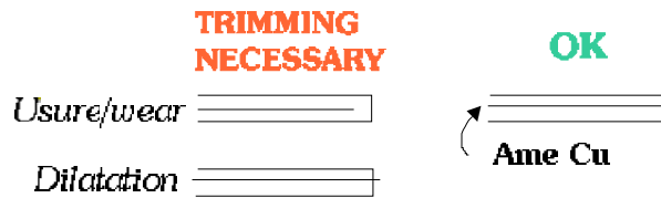
Figure 8 : Principe de la coupe de brins du peigne.
