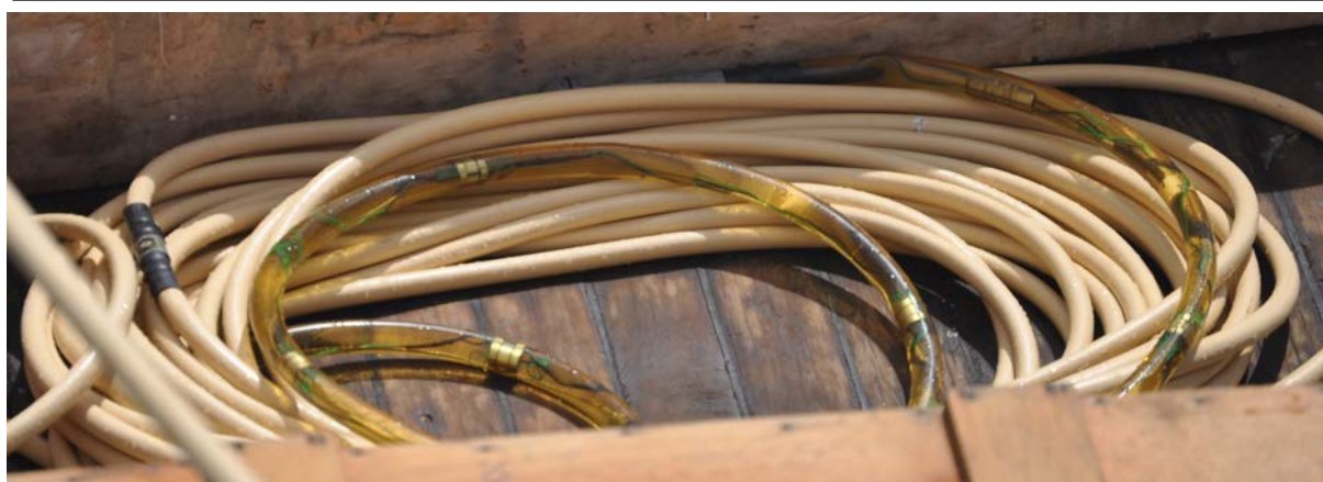
Figure 11 : Schéma de la flûte monotrace et photo de la flûte enroulée
