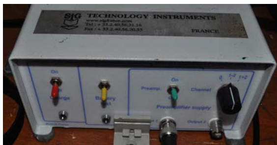
Figure 12 : Alimentation de la flûte 1 trace.
