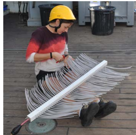
Figure 7 : Schéma de montage de l'électrode et photo d'un peigne 200 brins.
