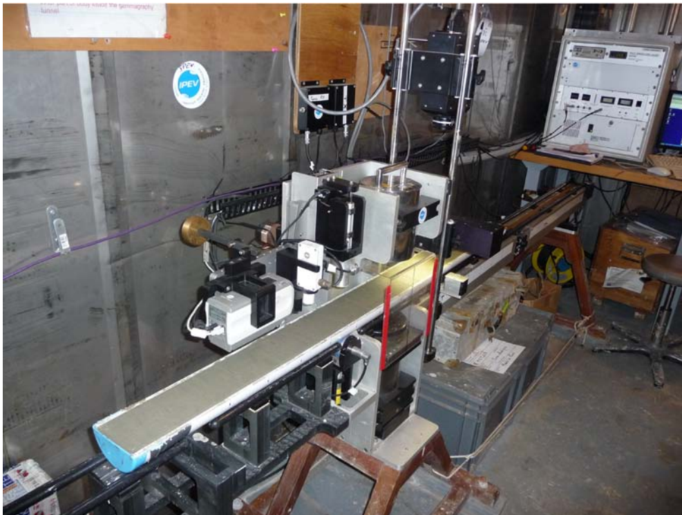
Vue générale du banc MST, avec le spectrophotomètre monté en ligne.
