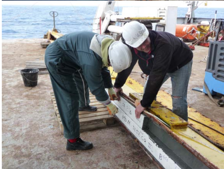
Echantillonnage du carottier Casq
