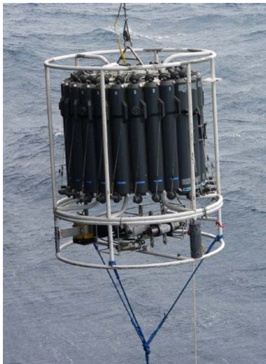
Vue générale de la rosette pour les prélèvements d'eau à différentes profondeurs
