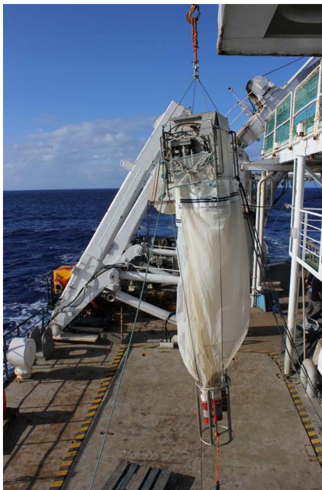
Le filet « Multinet » instrumenté pour prélèvements de micro-organismes à différentes profondeurs
