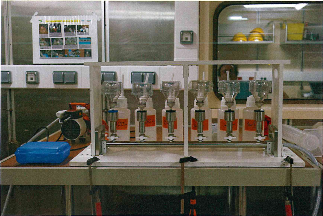
Photo 5. Poste filtration labo humide pour les prélèvements à la CTD
