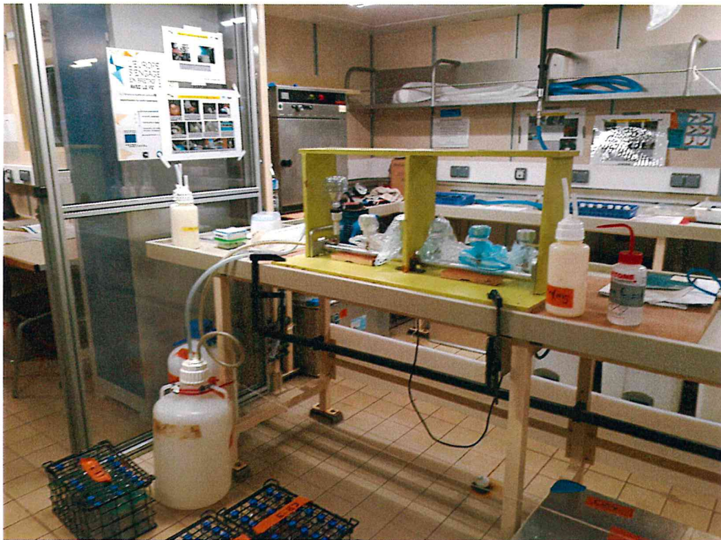
Photo 6. Poste filtration labo biologie pour les prélèvements à la FerryBox
