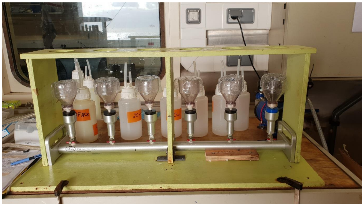
(Poste de filtration - laboratoire humide – tribord – pont C)
