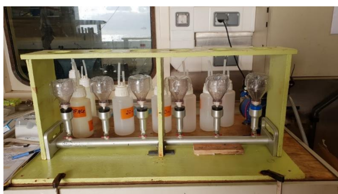
Image 2 : Poste de filtration pigments et POM - laboratoire humide – tribord – pont C
