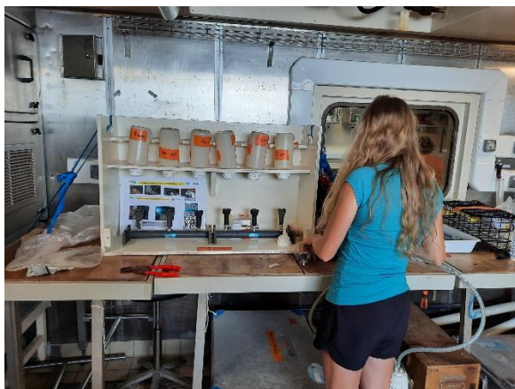
Image 1 : Poste de filtration pigments et POM - laboratoire humide – tribord – pont C
