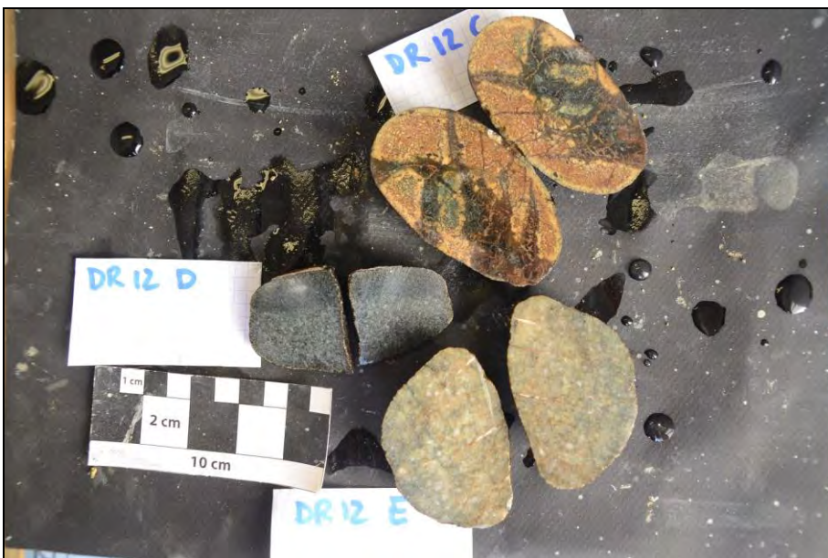
Figure 61 : Photographie des échantillons DR12-C, D, et E correspondant respectivement à des galets isolés de serpentinite oxydée à sulfures, de gabbro à sulfures et de diorite ou de granitoïde.
