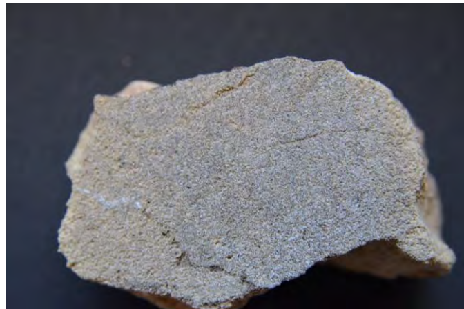
Figure 40 : Photographie de l'échantillon DR6-B après découpe à la scie à roche correspondant à grès siliceux à cristaux de dolomie et agrégat de foraminifères planctoniques
