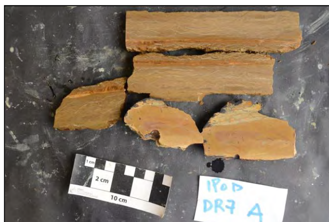
Figure 43: Photographie de l'échantillon DR7-A après découpe à la scie à roche correspondant à une argile silteuse carbonatée oxydée et relativement indurée avec quelques lits de silts et sables (turbidites fines)
