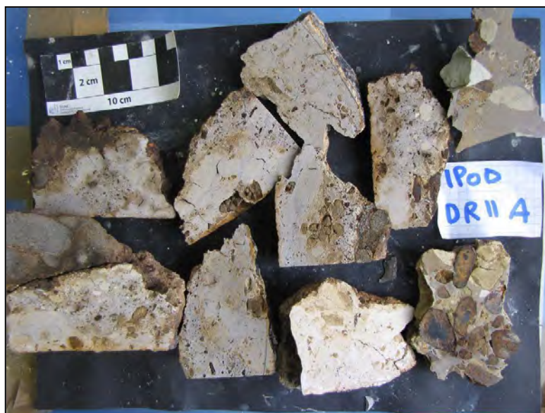
Figure 54: Photographie de l'échantillon DR11-A correspondant à des conglomérats biolithoclastiques à matrice micritique
