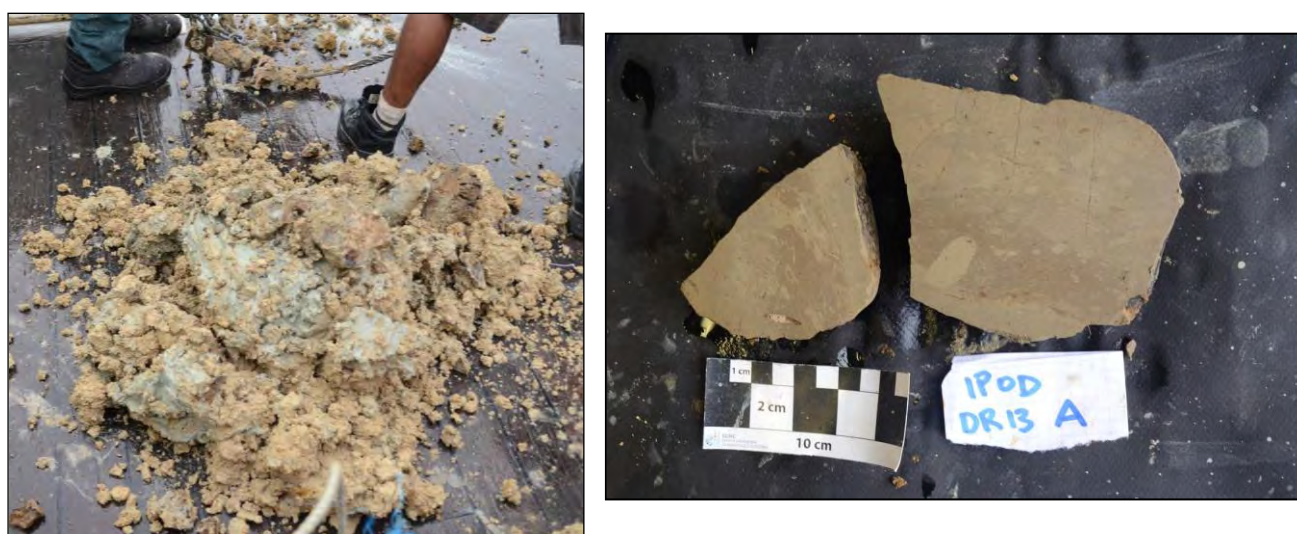
Figure 63: Photographie du dragage DR13 sur le pont arrière (à gauche) et de l'échantillon DR13-A représentatif de l'ensemble du dragage DR13 (à droite) correspondant à argilite bioturbée carbonatée montrant quelques points de rouilles
