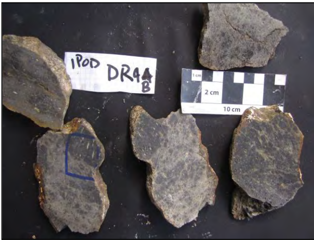
Figure 27: Photographies des échantillons DR4-B et DR4-H2 correspondant à des basaltes vacuolaires et altérés, autobréchifiés à vésicules étirées et filonets remplis de calcite ou silice
