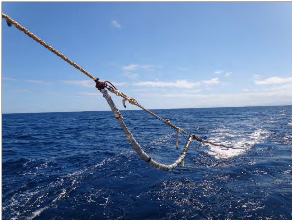
Figure 9: Mise en place d'une bosse pour réduire la tension sur le connecteur et pouvoir continuer l'acquisition
