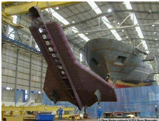
Figure 7 – Gondole sous-coque du BHO Beautemps-Beaupré
